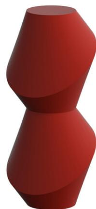
Le modèle est décomposé grâce à un logiciel de modélisation. Il est divisé en différentes silhouettes pouvant s'emboîter les unes dans les autres. Ces formes sont découpées dans du carton à l'aide d'une découpe laser.
